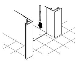
SI NECESSAIRE REPASSER AVEC UN FORET DIAMETRE 3 LES TROUS DE FIXATION DU GUIDE DE COULISSEMENT.
