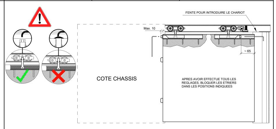
SI NECESSAIRE ADAPTER EN HAUTEUR LA BUTEE EN ALUMINIUM PUIS LA METTRE EN PLACE; FAIRE LE REGLAGE PAR LA VIS RAPID-BLOCK. FIXER AVEC LES VIS 4. 5X60.
