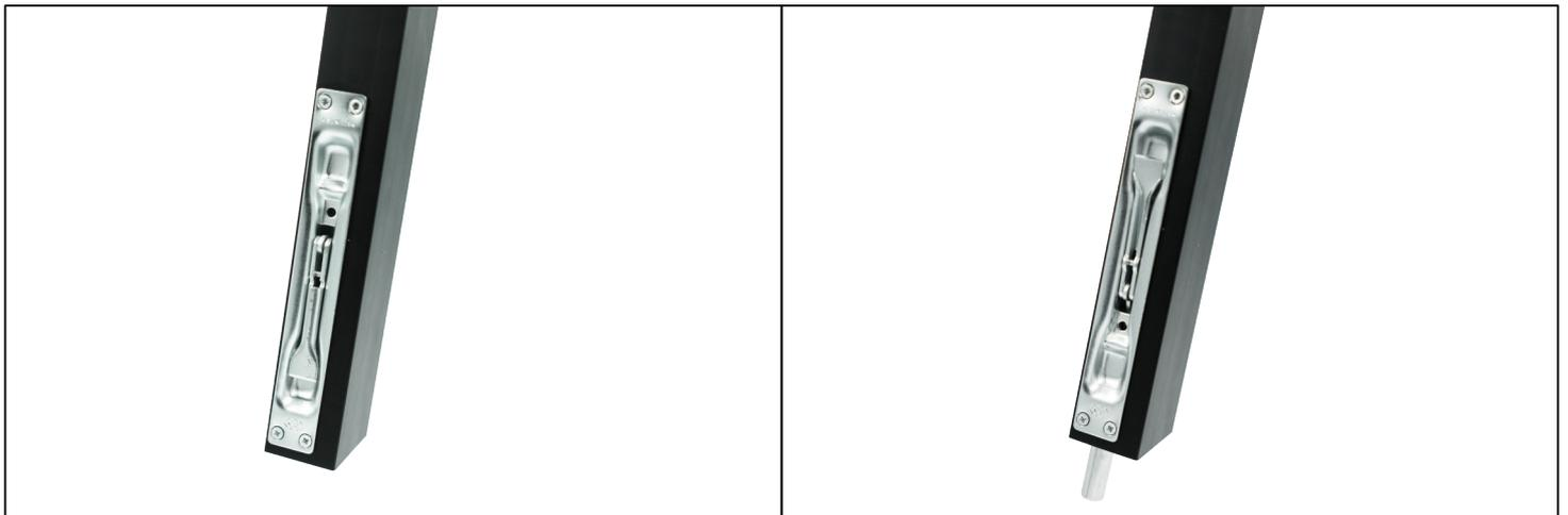
Le verrou à larder est mis en place sur l'un des deux vantaux pour le rendre semi fixe. La course du verrou est de 28mm et son diamètre est de 11 mm
