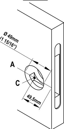
Fräsen Sie ein Loch (Ø49mm) halb durch die Tür von beiden Seiten um eine Beschädigung durch Splittern zu vermeiden.
