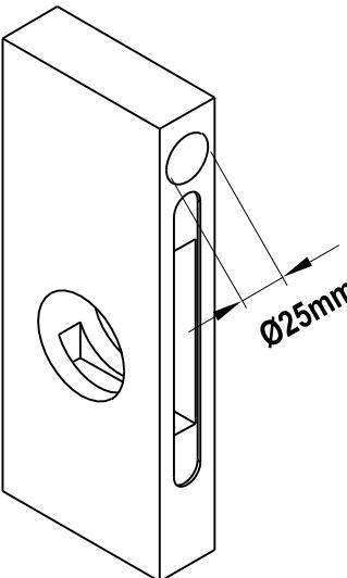
Fräsen sie an der Stirnseite der Tür mit einem Durchmesser von Ø25mm, ein 25mm tiefes Loch für die Fingermuschel. Auf Kundenwunsch können Sie die Fingermuschel versetzen. Die Maße betragen Ø29mm x 1,6mm (Eckige Version 29mm x 29mm x 1,6mm)
