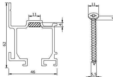
NOTA : Afin de respecter l'encombrement maximal, les têtes de vis doivent avoir un Ø de 11mm max et une hauteur max de 4 mm (hors fraisage).
