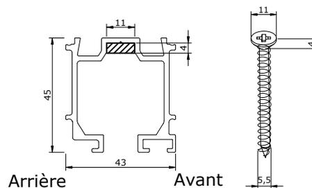
NOTA : Afin de respecter l'encombrement maximal, les têtes de vis doivent avoir un Ø de 11mm max et une hauteur max de 4 mm (hors fraisage).
