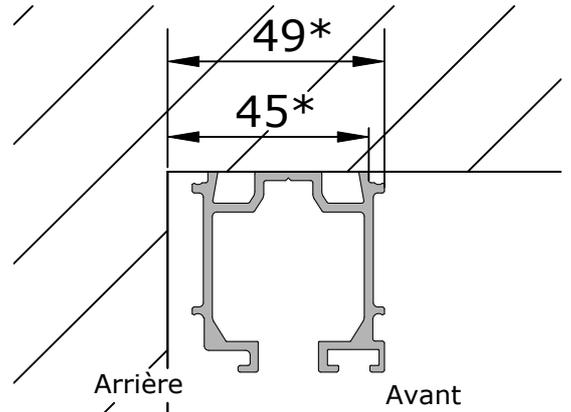
\* Si présence de plinthe, additionnez l'épaisseur de plinthe à 49
