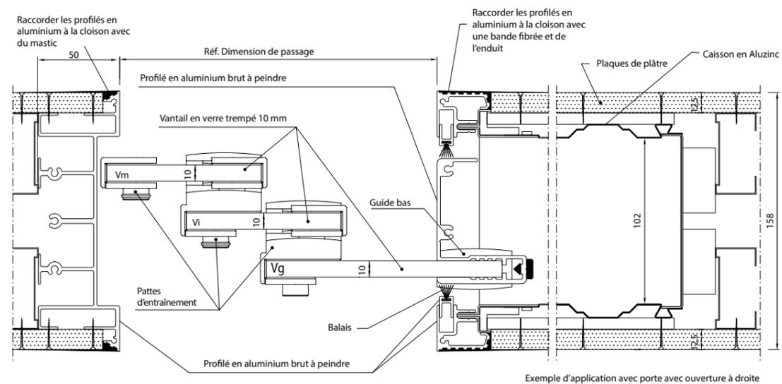
Galndage pour verres coulissants escamotable sans kit de finition pour cloison en enduit de 140 mm
